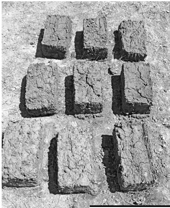
СЫРЦОВЫЕ КИРПИЧИ ДЛЯ СТЕН РЕСТАВРАТОРЫ ИЗГОТОВЛИВАЮТ ВРУЧНУЮ НЕПОСРЕДСТВЕННО НА МЕСТЕ.
